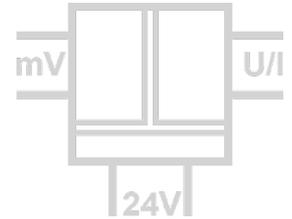
Der Shunt/mV-Trennverstärker DS 75000 dient zur galvanischen Trennung und Wandlung von bipolaren und unipolaren mV-Spannungen, wie sie oft bei der Strommessung mit Shunt-Widerständen auftreten oder sonstigen Applikationen mit kleinen Sensorspannungen.
