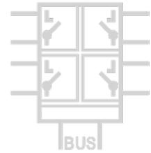
Mit dem Modbus 4-Kanal Relaismodul können vier elektrisch isolierte Relais über eine Modbus-Schnittstelle geschaltet werden. Zur Beeinflussung des Schaltverhaltens können verschiedene Zeitfunktionen verwendet werden.
