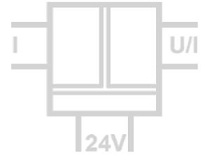
Der Speisetrenner DC 52100 dient zur Speisung und Trennung von 2- und 3-Leiter Transmittern und aktiven Sensorsignalen.
