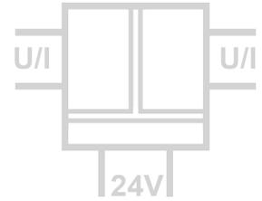
Der Bipolar-Trennverstärker DB 68 dient zur galvanischen Trennung und Wandlung von bipolaren und unipolaren Industriesignalen.
