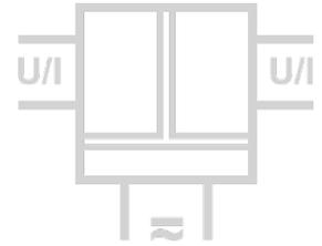
Der Invers-Trennverstärker DB 6250 dient zur galvanischen Trennung und Wandlung von Industriestandardsignalen mit inverser Kennlinie.
